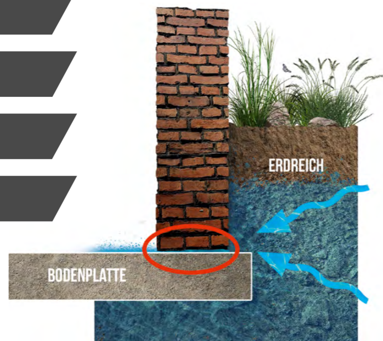
* Defekter bzw. undichter Boden-Wandanschluss
