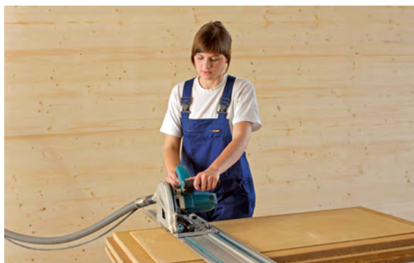
BKM LB-Klimaplatten können mit der Handkreissäge auf das passende Maß zugeschnitten werden.
